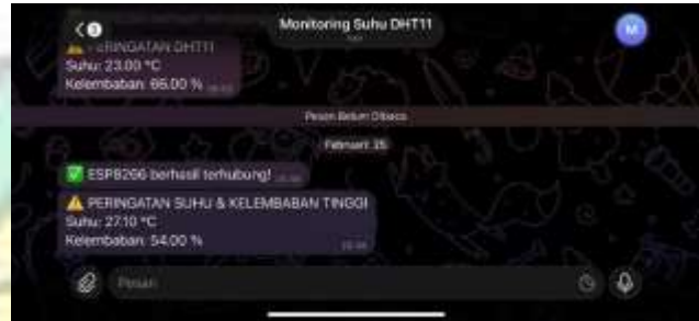
Gambar 6. Tampilan Notifikasi Bot Telegram "Monitoring Suhu DHT11" pada ponsel pengelola
