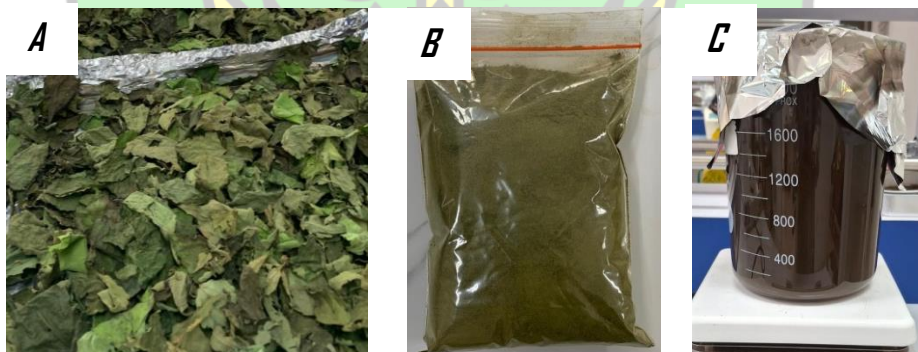
Gambar 4. 1 Proses dan hasil ekstraksi daun C. Odorata (a) daun kering sebelum digiling (b) hasil serbuk daun (c) larutan hasil ekstraksi (filtrat akhir).
