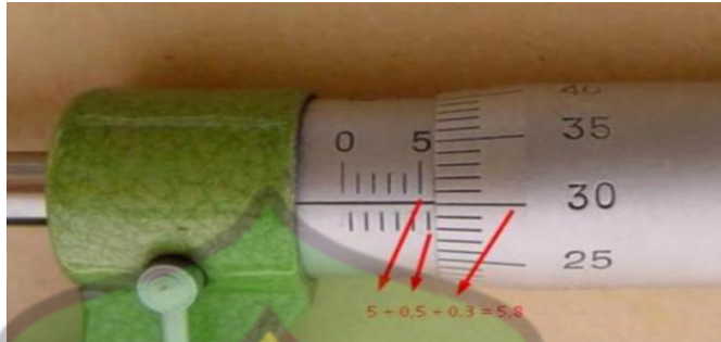
Gambar 2.3 Pengukuran ketebalan benda menggunakan mikrometer skrup (Sumber : Azhari, & Sianturi, 2021 )
