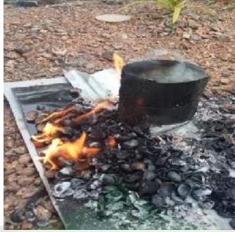
Gambar 3. 5 Proses Karbonisasi Manual Cangkang Pala
