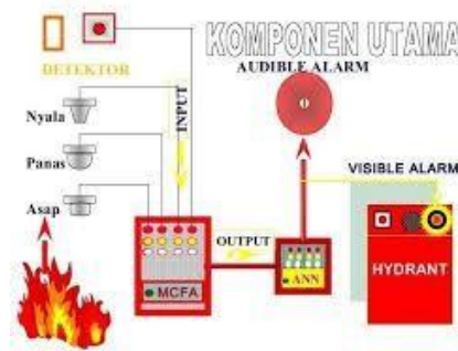
Gambar 4. 27 peringatan kebakaran dini
