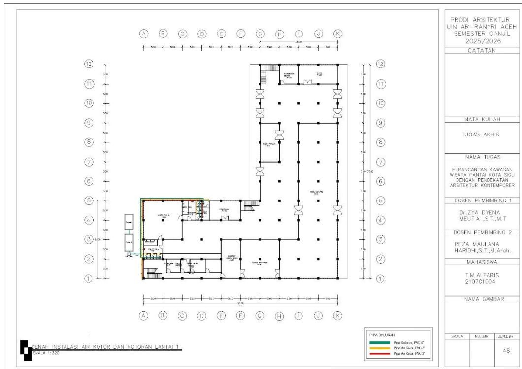
Gambar 6. 34 Denah Rencana Air Kotor Dan Kotoran Lantai 1
