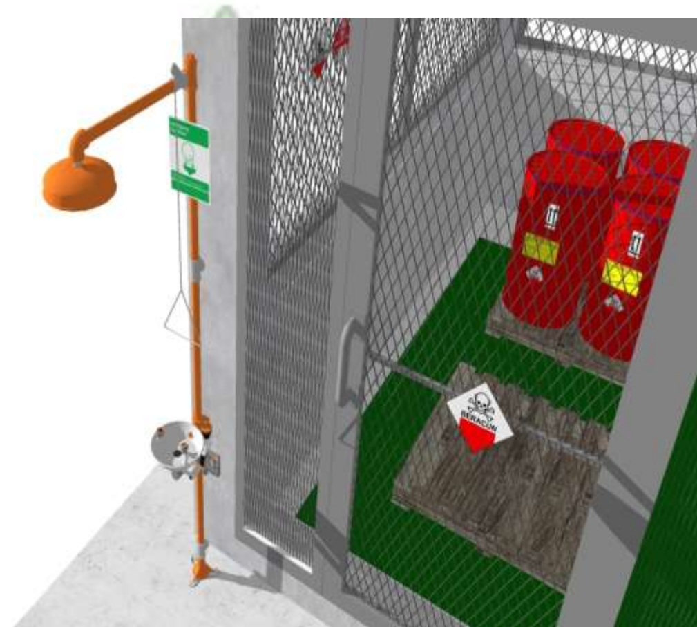
Tampak Fasilitas Keselamatan TPS Wastafel, Shower dan Eyewash Limbah B3
