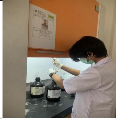
Penambahan pasir besi dengan HCL
