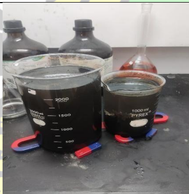
Proses pencucian pasir besi setelah pengadukan
