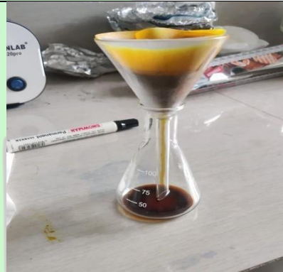
Proses penyaringan larutan pasir besi dan HCL
