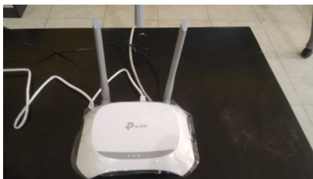
Gambar 4. Access Point TP-Link yang digunakan sebagai pemancar sinyal WiFi selama pengujian.
