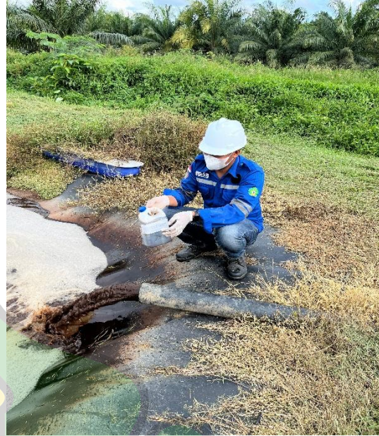
Pengambilan Sampel Anaerobik Sekunder
