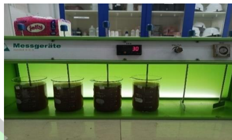
Gambar 4.7 Proses pengadukan cepat 150 rpm dan pengadukan lambat 30 rpm dengan biokoagulan biji alpukat
