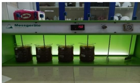
Gambar 4.7 Proses pengadukan cepat 150 rpm dan pengadukan lambat 30 rpm dengan biokoagulan biji alpukat
