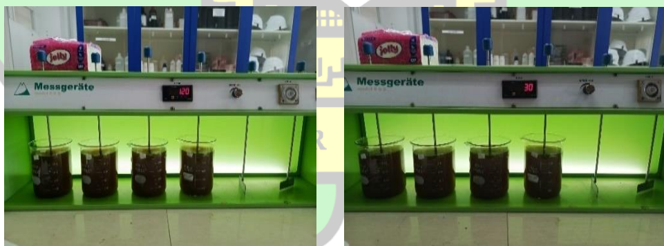
Gambar 4.6 Proses pengadukan cepat 120 rpm dan pengadukan lambat 30 rpm dengan biokoagulan biji alpukat
