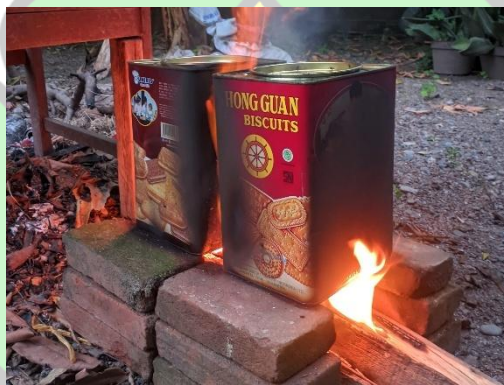
Gambar 3.7 Proses Karbonisasi secara manual
