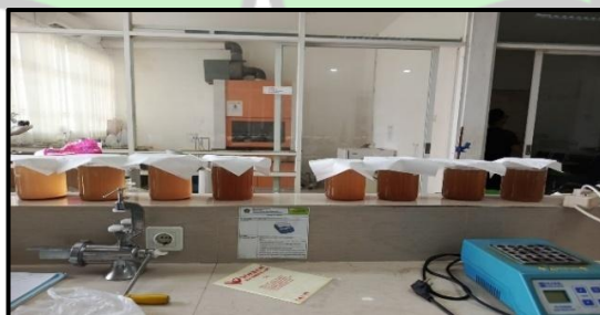
Gambar 4. 7 Proses pengendapan biokoagulan biji flamboyn
