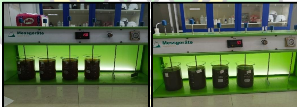
Gambar 4. 6 Proses pengadukan kecepatan 150 rpm dan pengadukan lambat 30 rpm dengan biokoagulan biji flamboyan
