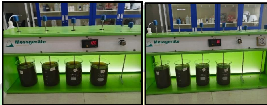
Gambar 4. 5 Proses pengadukan kecepatan 120 rpm dan pengadukan lambat 30 rpm dengan biokoagulan biji flamboyan
