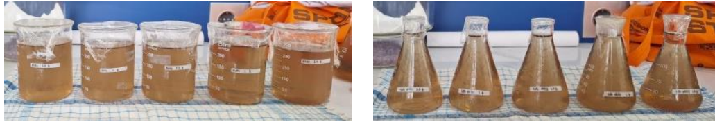
Gambar 4.3 Filtrat Sampel Setelah Pengendapan, Arang Teraktivasi (kiri) dan Arang Tidak Teraktivasi (kanan)
