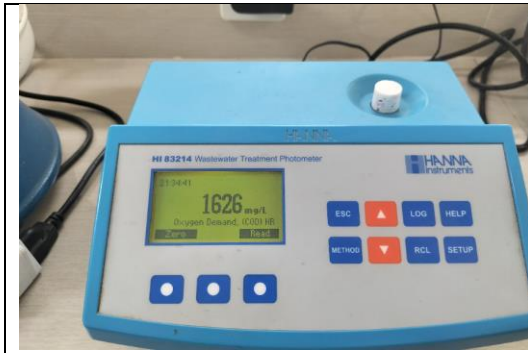
Pengukuran nilai COD dengan COD meter
