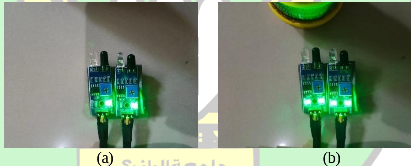
Gambar 3. 3. (a) Sensor Tidak Dilalui Oleh Kendaraan. (b) Sensor Dilalui Oleh Kendaraan.
