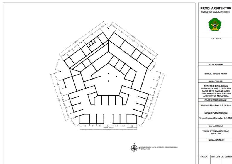
Gambar 6. 28 Denah Balok Latai Gedung Pelelangan Ikan
