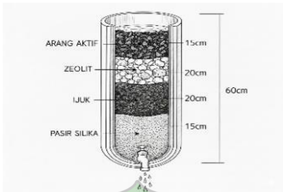
Gambar 3.4 Rancangan proses filtrasi air lindi
