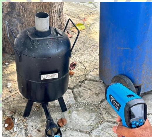
Gambar 3.2 Oven biochar yang digunakan untuk proses karbonisasi sekam padi
