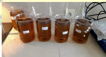
Gambar 4.4 Proses Pengendapan Air Limbah RPH Setelah Penambahan Biokoagulan Ekstrak Buah Kulit Buah Pisang Kepok
