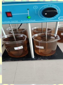
Gambar 4.3 Proses Pengadukan Cepat 30 Rpm dengan Biokoagulan Ekstrak Kulit Buah Pisang Kepok
