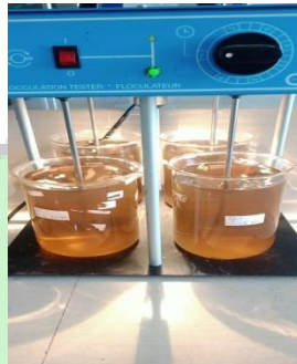
Gambar 4.2 Proses Pengadukan Cepat 120 Rpm dengan Biokoagulan Ekstrak Kulit Buah Pisang Kepok
