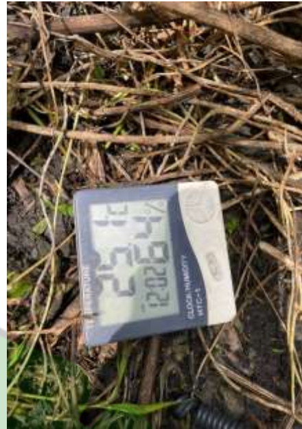
hygro-thermometer untuk mengukur suhu dan kelembaban
