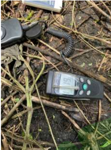
Lux meter untuk mengukur intensitas cahaya
