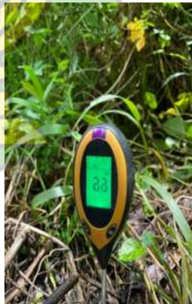
pH meter untuk mengukur pH kelembaban udara tanah
