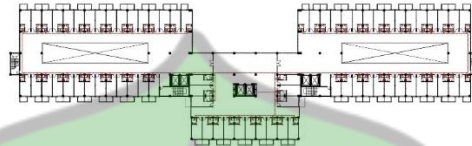
DENAH RENCANA INSTALASI AIR KOTOR LANTAI 3 REVISI : 01
