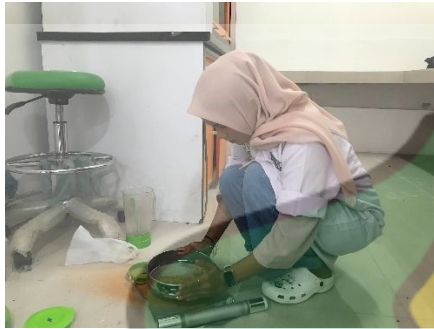
Penyaringan kulit alpukat dengan ayakan 100 mesh.
