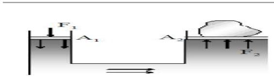
Gambar 2.3 Pengisap dongkrak hidrolik
