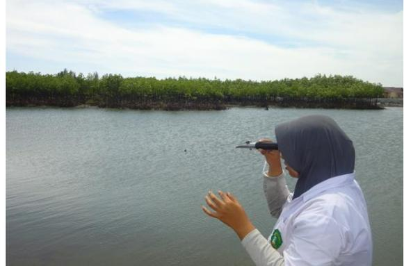
Gambar 2. Mengukur salinitas air
