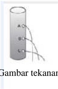
Gambar tekanan Hidrostatik
