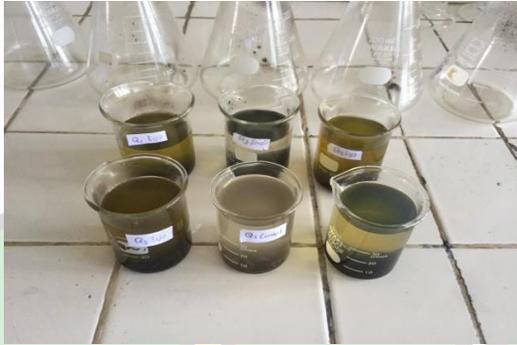
6. Masukkan larutan sampel ke dalam oven pada suhu 70°C hingga semua pelarut menguap estimasi selama 8 jam
