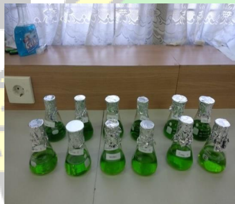
Gambar: Ekstrak klorofil ditutup dengan kertas aluminium foil
