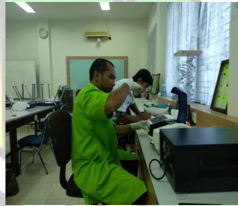
Gambar: Mengukur kandungan klorofil dengan spektrofotometer Jenway 6300
