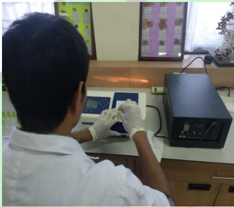
Gambar: Mengukur kandungan klorofil dengan spektrofotometer Jenway 6300
