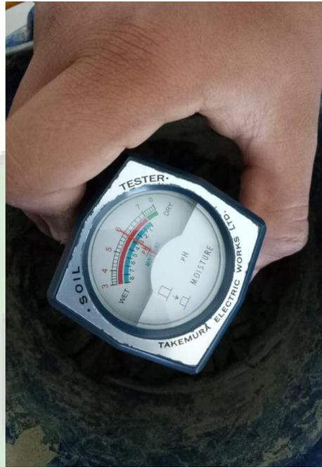
Gambar 10. Pengecekan pH sedimen setelah fitoremediasi
