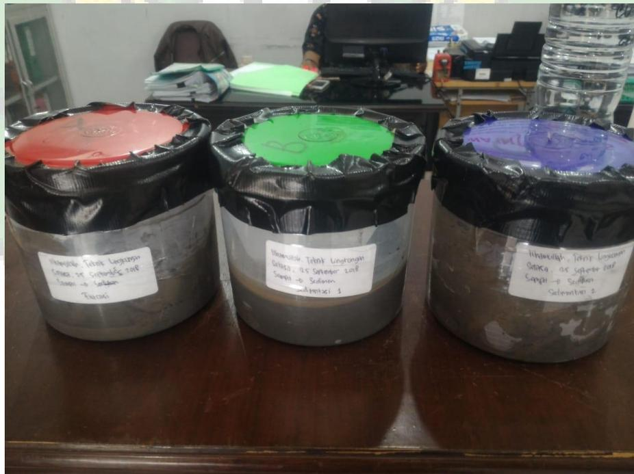
Gambar 4. Sampel sedimen sebelum fitoremediasi dan siap dilakukan pengujian di laboratorium BARISTAND
