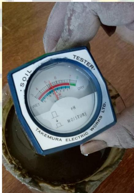
Gambar 9. Pengecekan pH aluminium pada sedimen sebelum fitoremediasi
