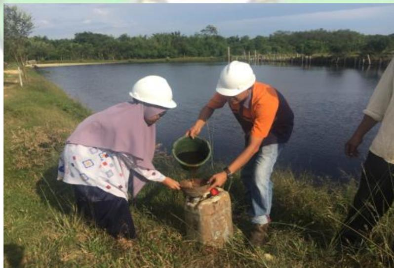
Keterangan: Proses pengambilan sampel limbah cair kelapa sawit untuk dibawa ke laboratorium.
