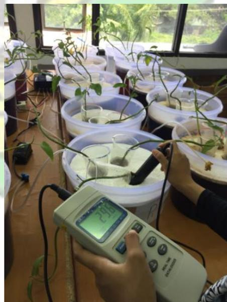
Keterangan: Proses pengujian Suhu dan oksigen terlarut.
