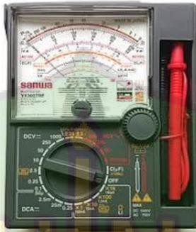
Gambar 2.4 Multimeter Analog<sup>27</sup>
