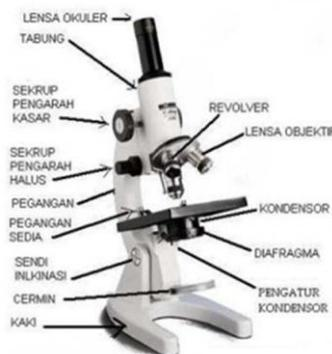
Gambar 2.4. Bagian-bagian pada mikroskop.
