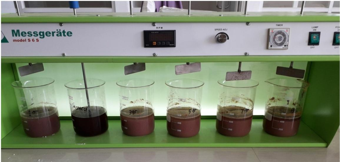
Gambar Sampel Air Limbah Setelah Proses Koagulasi Dan Flokulasi Selanjutnya Dilakukan Proses Sedimentasi Selama 60 Menit
