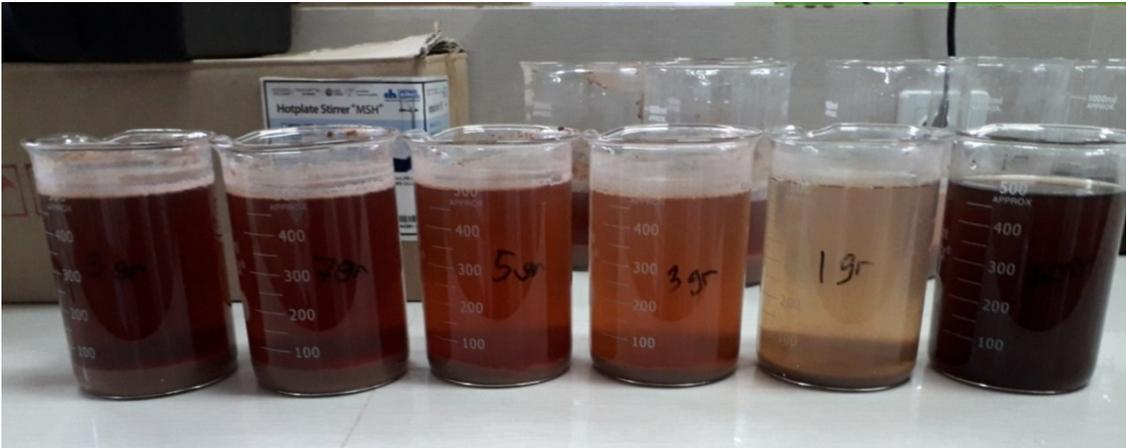
Gambar Sampel Air Limbah Industri Pengolahan Ikan Setelah Proses Koagulasi, Flokulasi dan Sedimentasi
