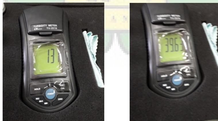
Gambar Uji Nilai Kekeruhan Sampel Air Limbah Setelah Perlakuan *Jartest*
