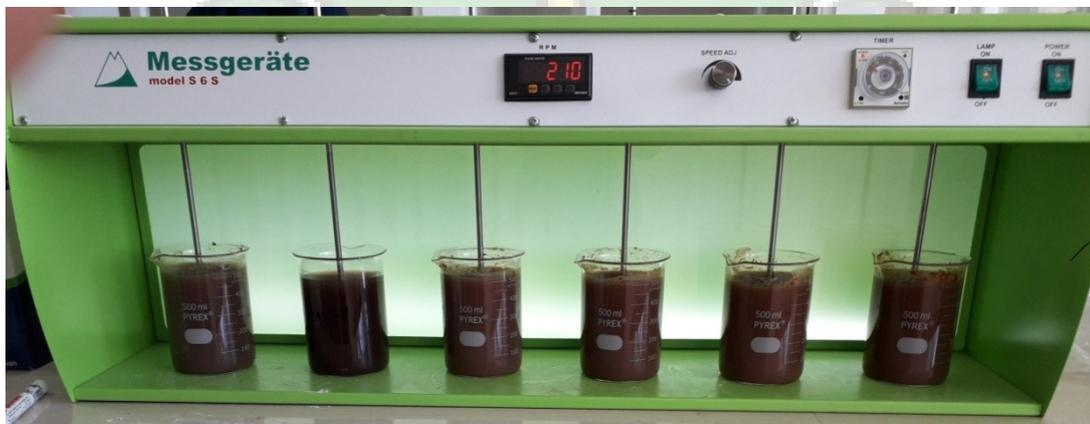
Gambar Sampel Air Limbah Industri Pengolahan Ikan Sedang Dalam Proses Koagulasi Dengan Kecepatan 210 rpm Selama 3 Menit
