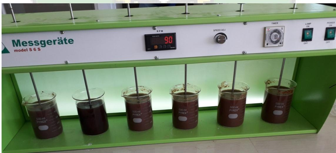
Gambar Sampel Air Limbah Industri Pengolahan Ikan Sedang Dalam Proses Flokulasi Dengan Kecepatan 90 rpm Selama 12 Menit
