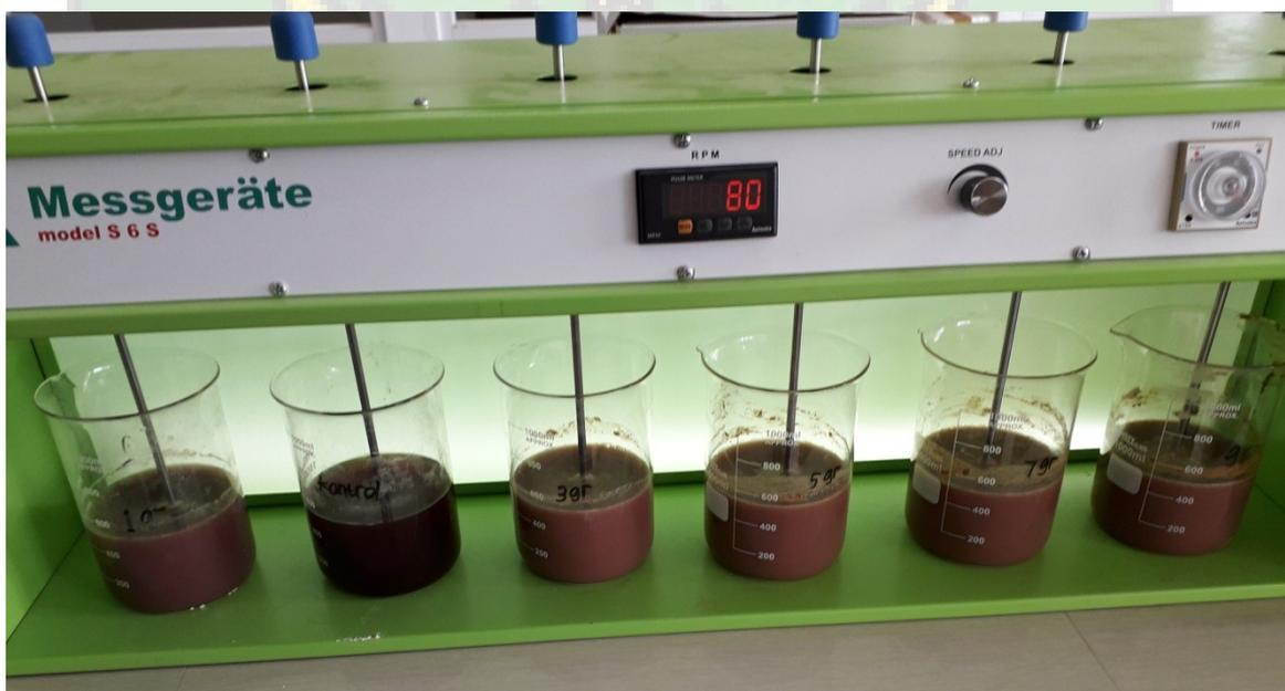
Gambar Sampel Air Limbah Industri Pengolahan Ikan Setelah Proses Koagulasi Dan Dilanjutkan Proses Flokulasi Dengan Kecepatan 80 rpm Selama 12 Menit
