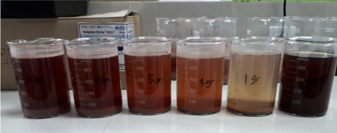
Gambar 4.14 Sampel Air Limbah Industri Pengolahan Ikan Setelah Proses Koagulasi, Flokulasi dan Sedimentasi
