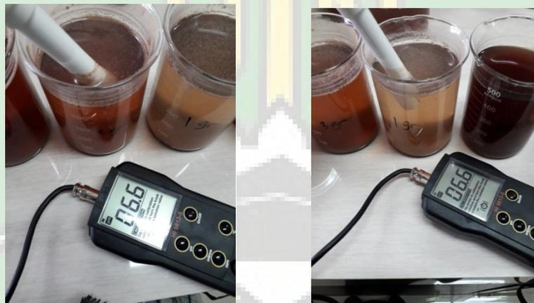
Gambar Uji Nilai pH Sampel Air Limbah Setelah Perlakuan *Jartest*
