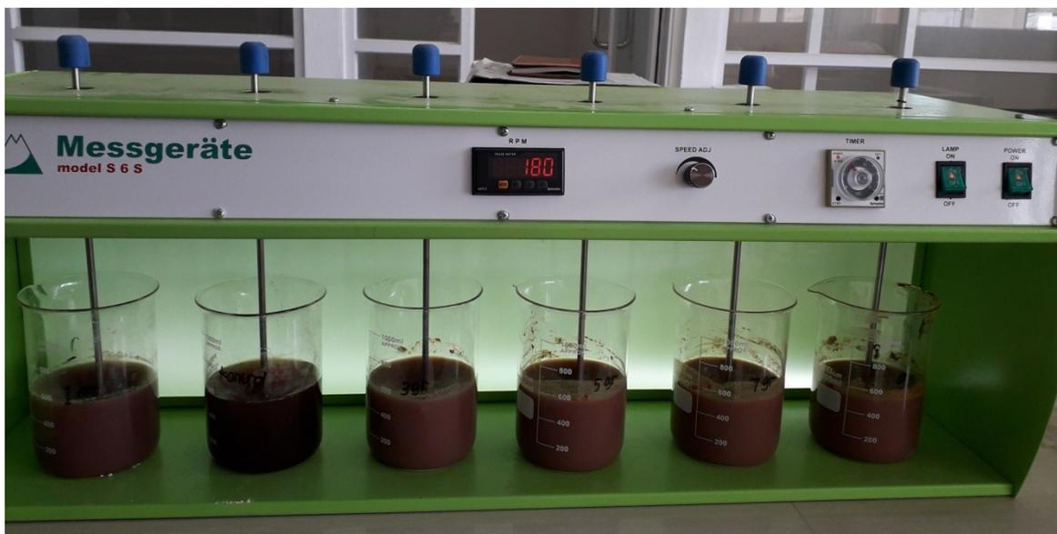
Gambar Sampel Air Limbah Setelah Ditambah Koagulan Biji Asam Jawa dan Dilakukan Proses Koagulasi Dengan Kecepatan Pengadukan Cepat 180 rpm Selama 3 Menit
