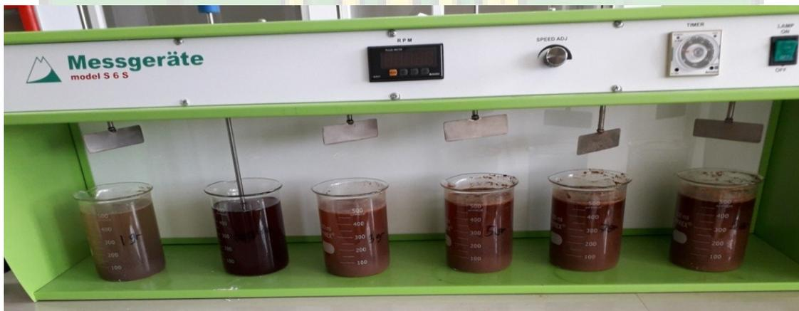
Gambar Sampel Air Limbah Setelah Ditambah Koagulan Biji Asam Jawa Dalam Sampel Air Limbah Industri Pengolahan Ikan
