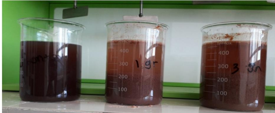
Gambar Sampel Air Limbah Industri Pengolahan Ikan Setelah Ditambah Koagulan Biji Asam Jawa Sebelum Perlakuan *Jartest*
