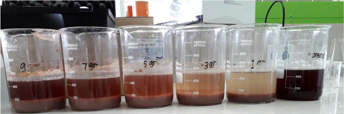
Gambar Sampel Air Limbah Industri Pengolahan Setelah Proses Koagulasi, Flokulasi dan Sedimentasi
