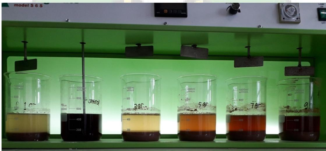
Gambar 4.13 Sampel Air Limbah Setelah Proses Sedimentasi Selama 60 Menit
