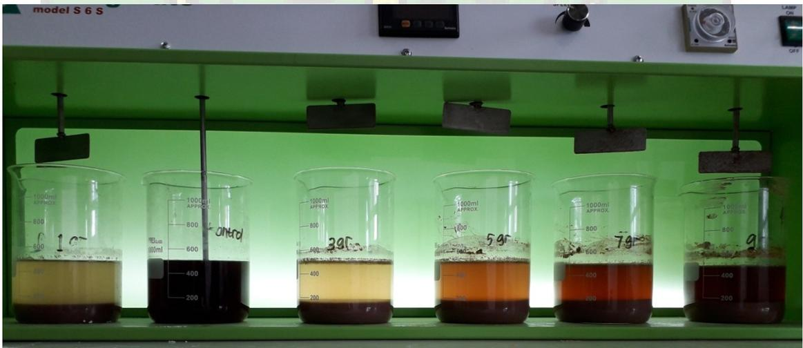
Gambar Sampel Air Limbah Setelah Proses Sedimentasi Selama 60 Menit
