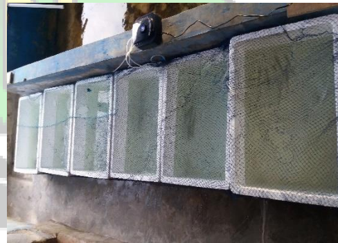
Proses pemaparan polutan timbal (Pb) dalam wadah fiber yang berisi 90 L air
