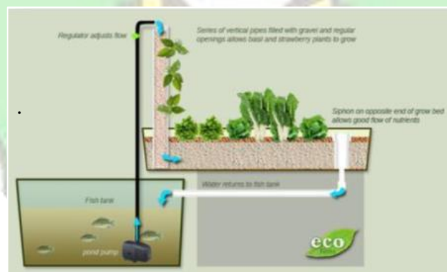
Gambar 2.9 Skema sistem aquaponik 61
