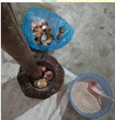
Gambar. 5 Penumbukkan Limbah cangkang telur
