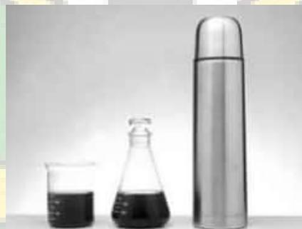
**Gambar 2.1** Sistem terbuka, sistem tertutup dan sistem terisolasi (Petrucci, dkk. 2011)
