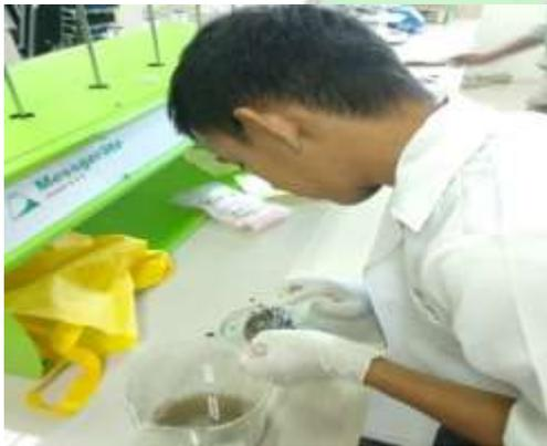
Penarikan partikel magnetik dalam sampel sedimen ekstraksi dengan menggunakan besi magnetik.
