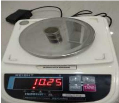
Sampel sedimen dimasukkan dalam holder untuk pengukuran susceptibilitas magnetik.
