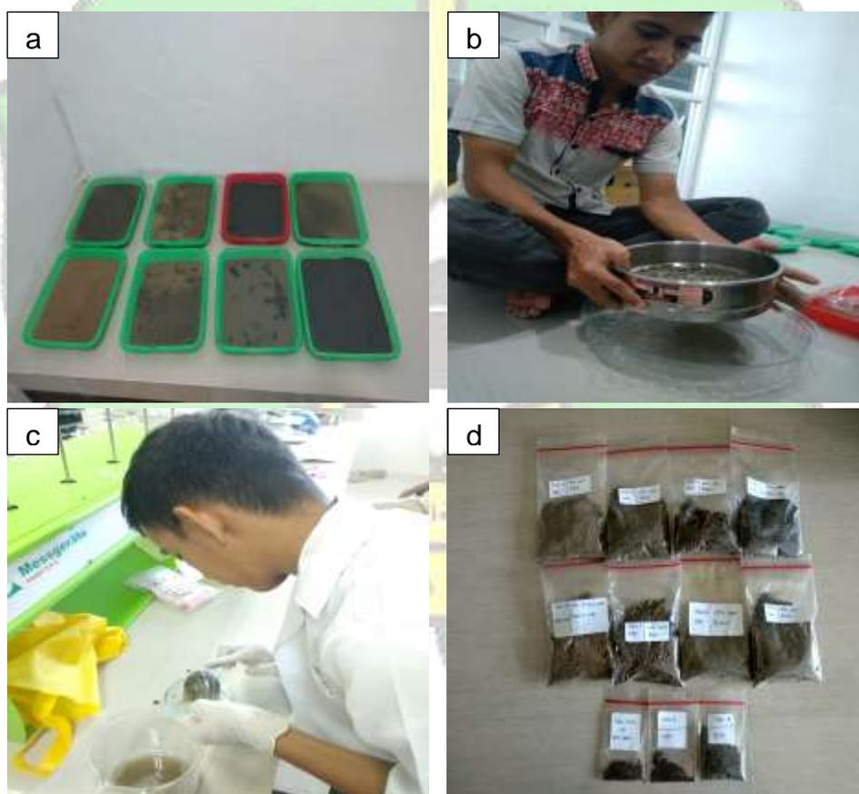
**Gambar 3.5** (a) Proses Pengeringan Sampel Sedimen, (b) proses penyaringan sampel sedimen, (c) Proses ekstraksi sedimen untuk pengukuran XRD dan SEM-EDS, (d) Sampel Sedimen dikemas dan diberi label
