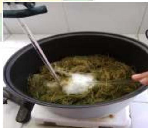
Gambar 5. Ekstraksi dengan  $\text{NaOH}$
