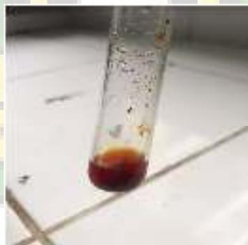
**Gambar 4.1.** Uji Iodin (Positif Selulosa)
