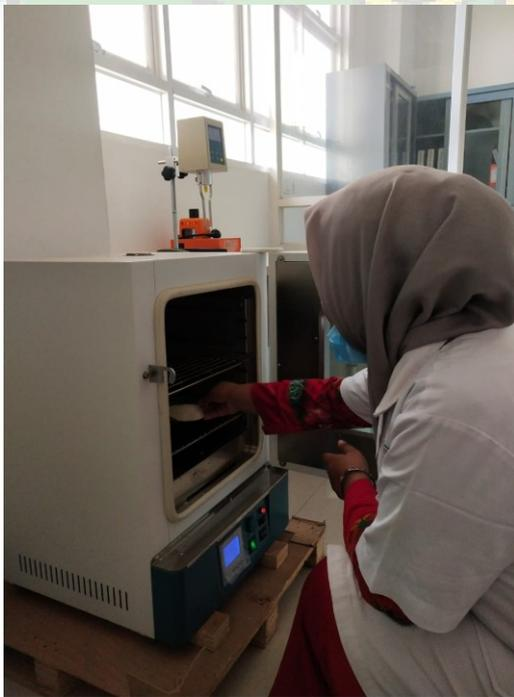
Gambar 7. Proses pemanasan dengan oven dengan suhu 60 °c
