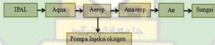
Gambar 5.44: Skema proses IPAL Sumber : Analisa Pribadi
