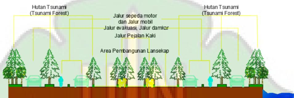
**Gambar 3.18** Penataan zona pengurangan dampak tsunami sebagai upaya mitigasi di dalam area rekreasi
