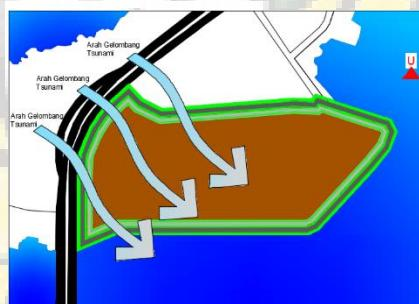
Gambar 3.20 Penentuan bentuk bangunan berdasarkan arah gelombang tsunami
