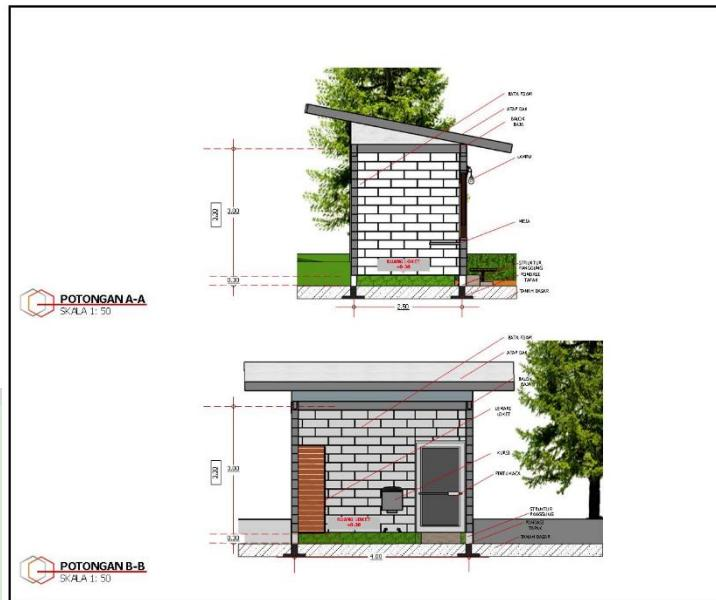
Gambar 6. 32 Potongan Loket Tiket
