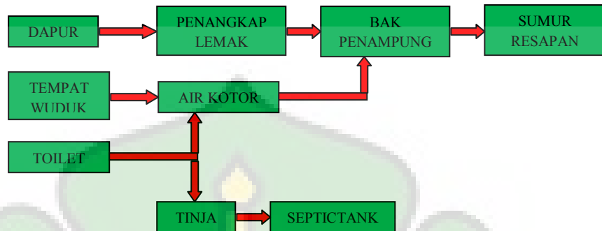
Skema 4.8 Sistem Pembuangan Air Kotor Sumber: Analisa Pribadi, 2019
