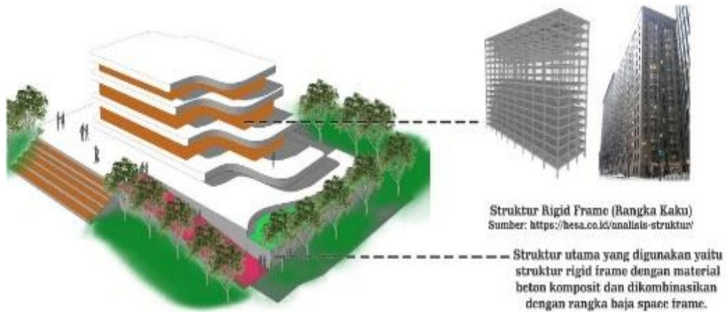
**Gambar 5.23** Ilustrasi Penggunaan Struktur *Rigid Frame*
