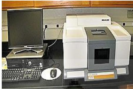
**Gambar 2.6** Alat Spektrofotometer FTIR (Rifansyah, 2016)
