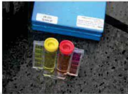
Gambar 2.11: alat pengukur kandungan pada air kolam renang
