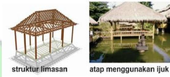
Gambar 5.25 : Struktur atap limasan
