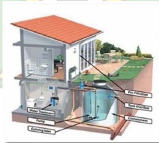
Gambar 2.12 Pemanenan air hujan di bawah tanah (Sumber: Components of A Rainwater Harvesting System, 1994)
