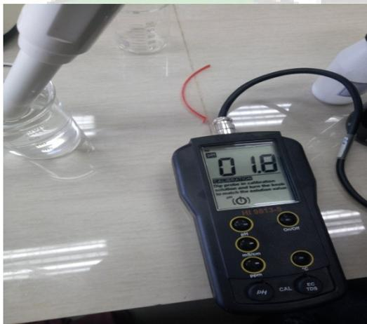
Pengukuran pH larutan logam setelah menambahkan larutan  $\text{HNO}_3$
