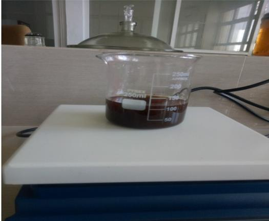
Proses pengadukan logam dan adsorben menggunakan *magnetic stirrer*
