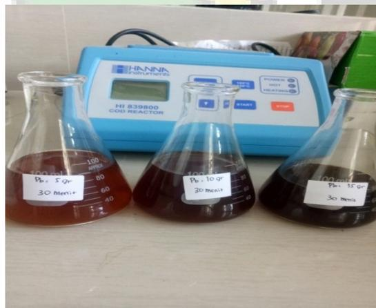
Larutan Logam setelah Adsorben disaring
