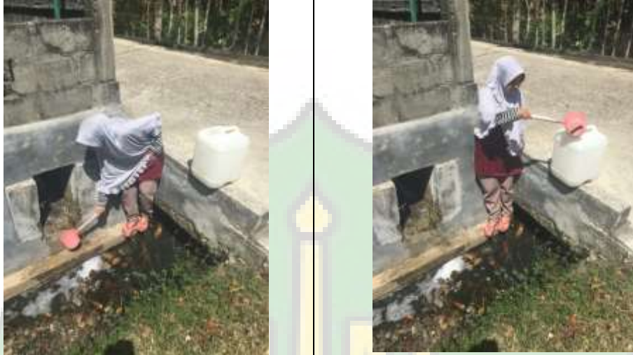
Pengambilan sampel limbah cair domestik di Dusun Mon Blang, Gampong Lamhlom, Kec. Lhoknga dengan metode Grab Sampel
