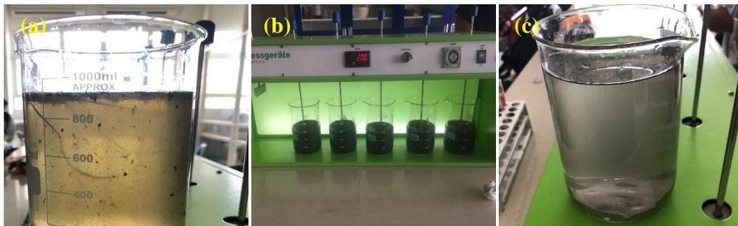
**Gambar 4.2** Pengolahan limbah domestik. a) sebelum pengolahan, b) proses pengolahan dengan arang aktif nanopartikel, c) setelah pengolahan dengan arang aktif nanopartikel.
