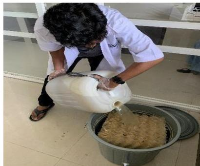
**7. sampel air limbah BIOfilter anaerob pada hari ke-5**
