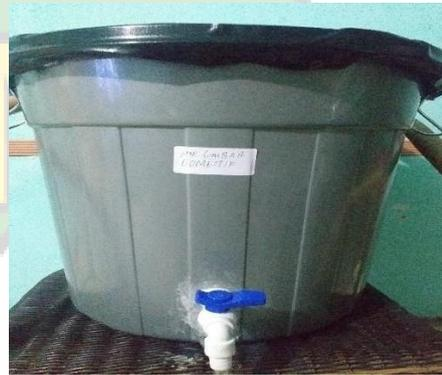
**Gambar 3.4.** Biofilter Anaerob Menggunakan Media Sarang Tawon
