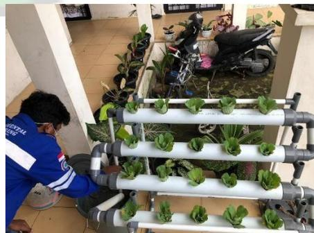
**13. Pengambilan sampel air limbah pada pengolahan hidroponik DFT**
