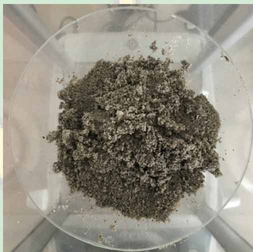
Batu apung yang telah di Modifikasi dengan Kitosan dan \text{Na}_2\text{S} 1 M
