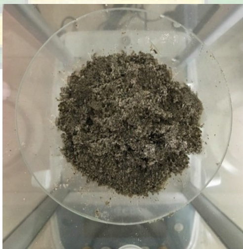
Batu apung yang telah di Modifikasi dengan Kitosan dan \text{Na}_2\text{S} 1 M
